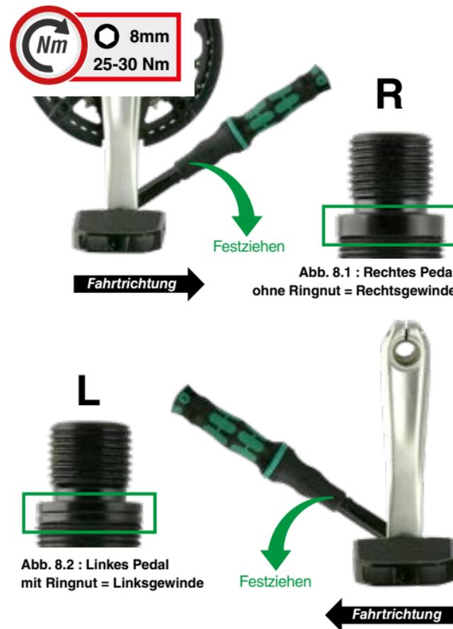
Abb. 8.1 : Rechtes Pedal ohne Ringnut = Rechtsgewinde
