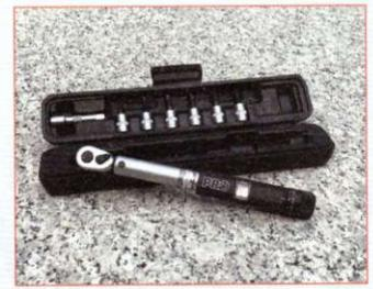
**DREHMOMENT:** Die Sattelstütze ist ein sicherheitsrelevantes Bauteil. Daher sollten alle Schrauben nach der Montage von Stütze und Sattel mit dem richtigen Drehmoment angezogen werden. Passende Modelle gibt es schon ab etwa 50 Euro im Fachhandel.
