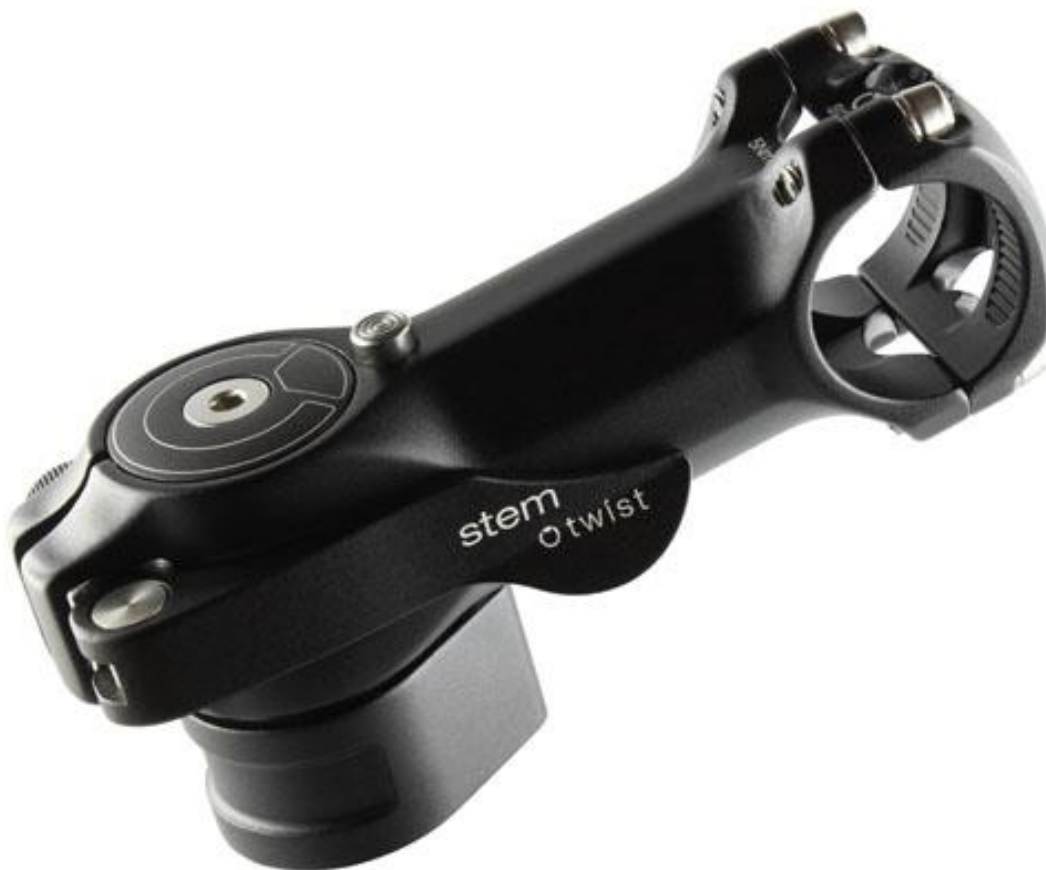
Der Stem twist SDS Vorbau erlaubt das schnelle seitliche Verdrehen des Lenkers ohne Werkzeuge.
